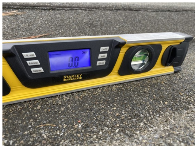
foto/30/ Pohled na změřený sklon v úžlabí střechy (změřeno cca 0,0%)
