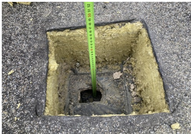
foto/13/ Pohled na provedenou sondu S1
