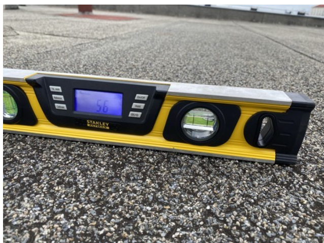
foto/27/ Pohled na změřený sklon v ploše střechy (změřeno cca 5,6%)
