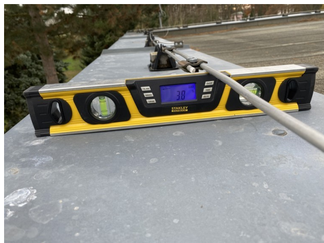
foto/36/ Pohled na změřený sklon atiky (změřeno cca 3,8 %)
