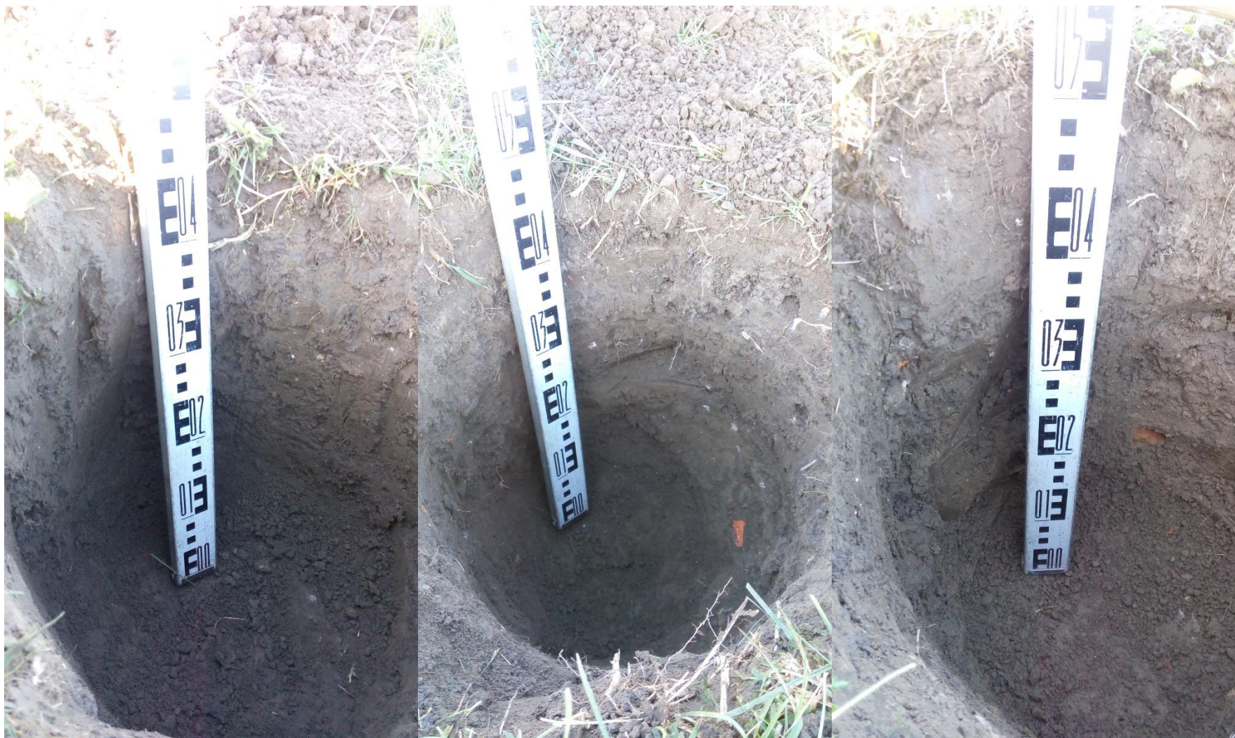
foto č. 1. - 3: Odkrytý půdní profil v sondách KS11 – KS12 – KS13. Svrchní půdní horizont tvoří ornice, následuje světle hnědé písčité podorničí.
