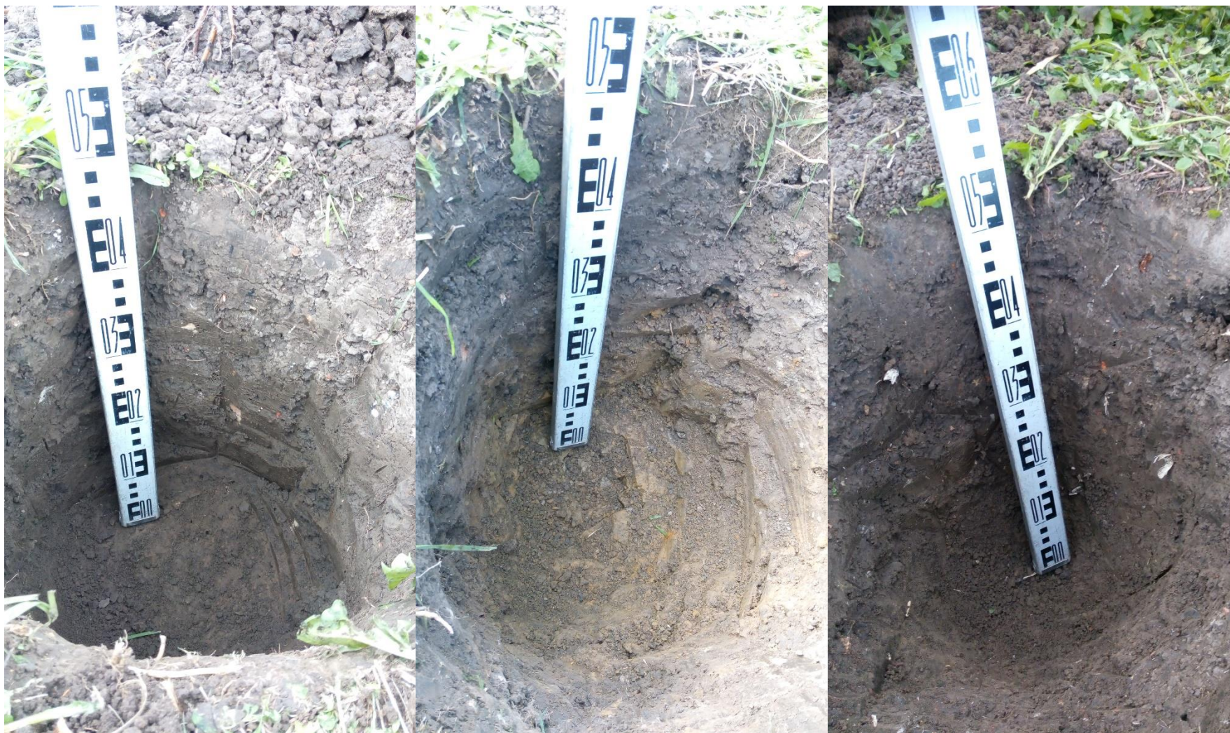
foto č. 4 - 6: Odkrytý půdní profil v sondách KS21 – KS22 – KS23. Svrchní půdní horizont tvoří ornice, následuje světle hnědé písčité podorníčí.
