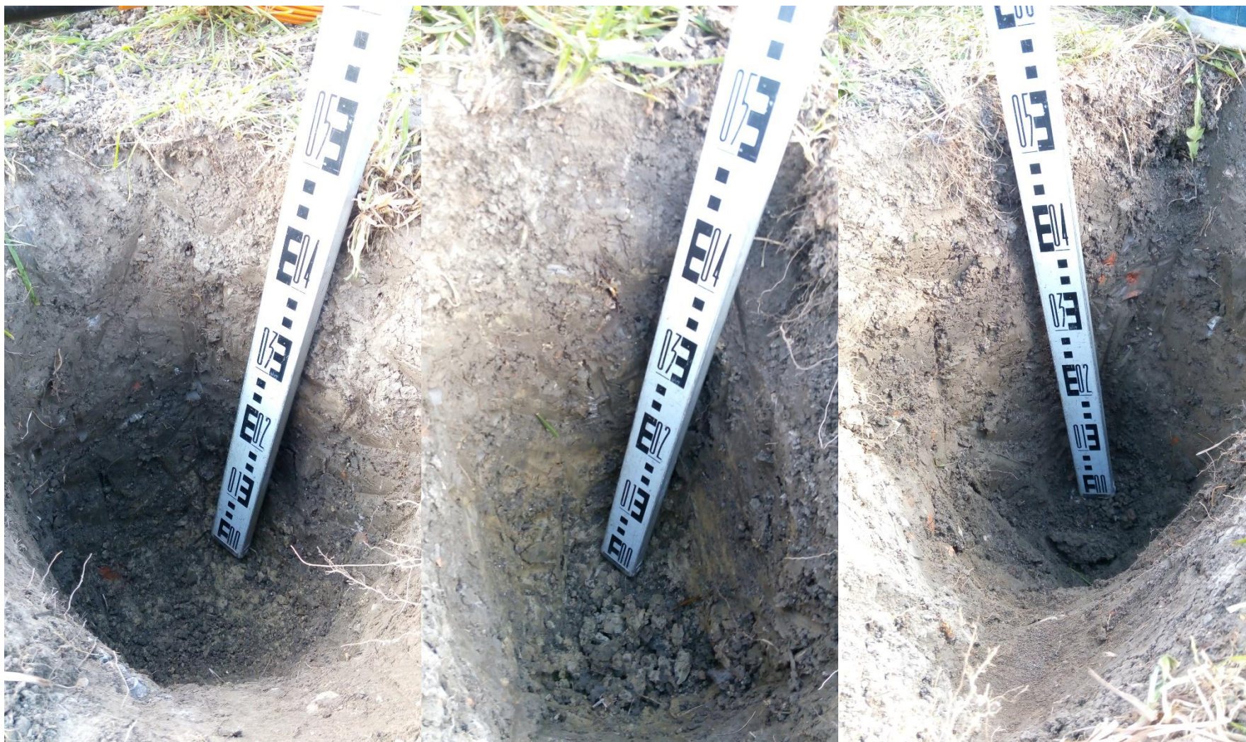
foto č. 10 - 12: Odkrytý půdní profil v sondách KS41 – KS42 – KS43. Svrchní půdní horizont tvoří ornice, následuje světle hnědé písčité podorničí.
