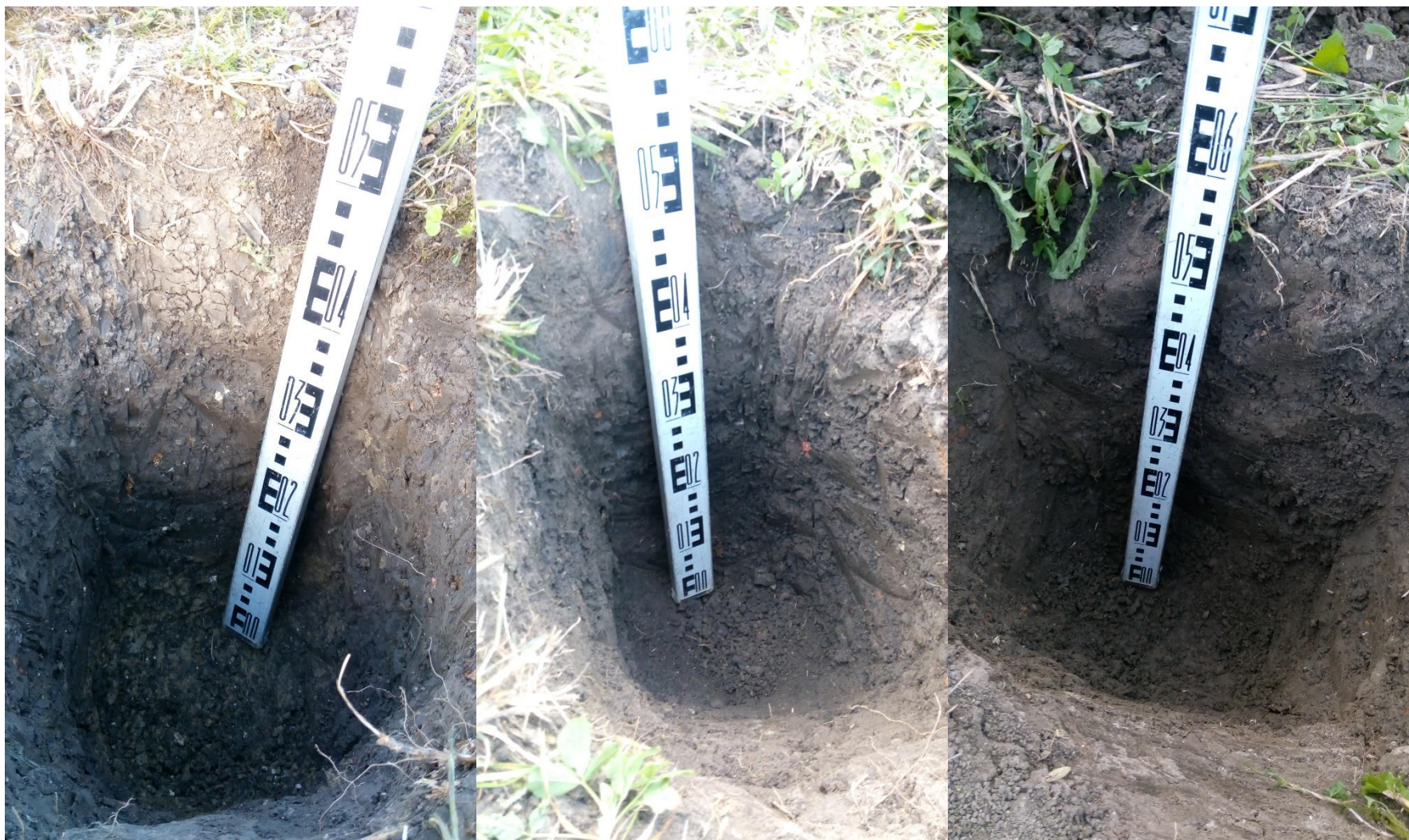
foto č. 7 - 9: Odkrytý půdní profil v sondách KS31 – KS32 – KS33. Svrchní půdní horizont tvoří ornice, následuje světle hnědé písčité podorníčí.
